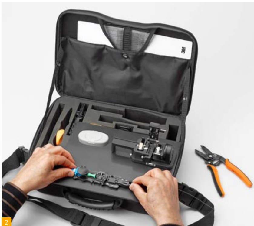
Der 3M-Montagekoffer: klein und handlich, dient als Arbeitsfläche für die Montagehilfe.
